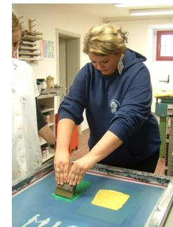
Dabei wird mit Hilfe einer digitalen Vorlage und eines Siebes ein Motiv auf verschiedene Materialien aufgedruckt.
